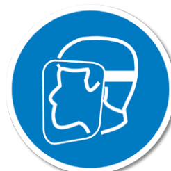
Visière de protection obligatoire
